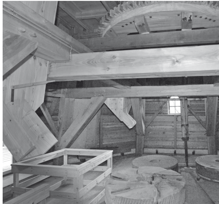
Zoals vaker in oostelijk Nederland is de baliezolder de steenzolder; op de voorgrond een pelsteen. Het binnenwerk moet nog verder aangebracht worden.
