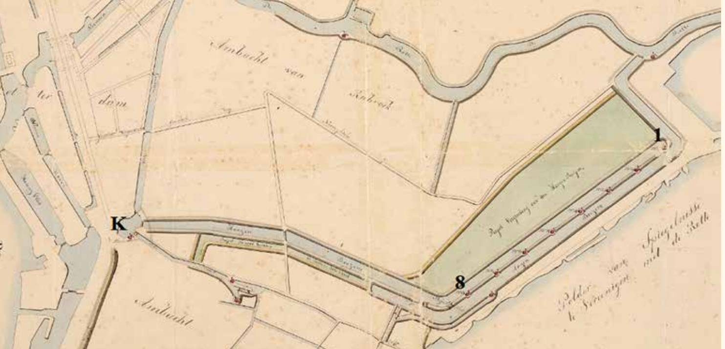
12. Plan voor uitbreiding van de hoge boezem van de Rotte in 1845. K = Oostplein met Kostverlorenmolen en spuilsuis, met ten noorden daarvan een verbindingskanaal met de Rotte. Ten zuiden van de molens 1-8 de lage boezem met rechts een verbinding met de Rotte. Ten noorden van de molens de hoge boezem met een verbindingskanaal naar het Oostplein. De vergroting van de hoge boezem betreft het groene gedeelte ten noorden van de boezemmolens (afbeelding uit het archief van het Hoogheemraadschap Schieland en de Krimpenerwaard).
