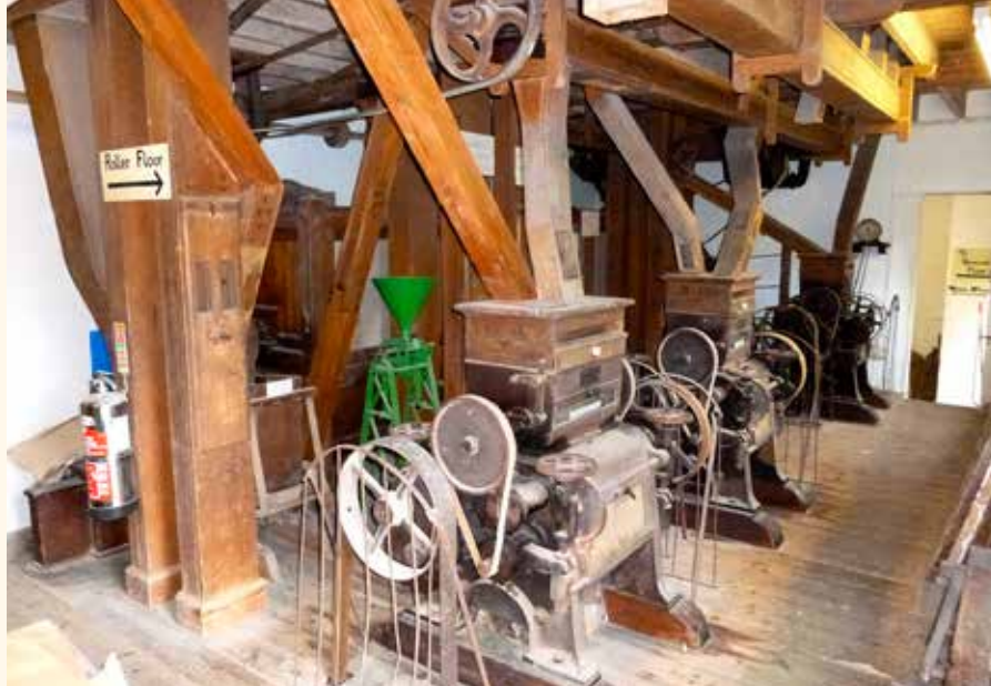
Drie walsenstoelen uit 1893, ook gefabriceerd en geïnstalleerd door Henry Simon. Ze bevinden zich in Calbourne Mill op het eiland Wight. De foto komt uit het boek van Harris, p. 92.
