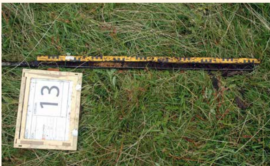
14. In deze boring door een van de vijvers van De Oude Blauw is in de zwarte grond duidelijk de roodbruine roestlaag van mangaan en ijzer te zien. De zwarte grond naast het bordje is de grond waarmee de vijver in latere tijd is opgevuld (foto Hollandia, Zaandijk, 2009).
