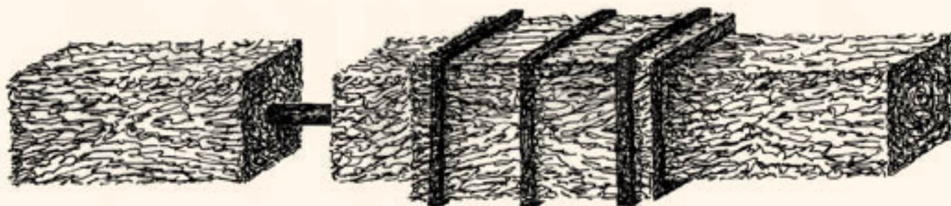
De gedeelde vierkante wateras met ijzeren pen en verschuifbare houten koker (tekening auteur, 2020).
