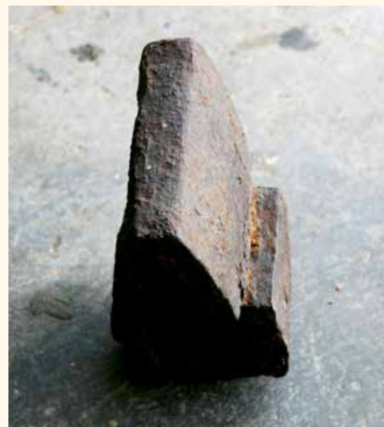
26. In de sloot bij de Meermolen in Muiderberg is deze ijzeren tand van de voormalige tandkrans gevonden (foto Jan Hofstra, 25 maart 2009).
