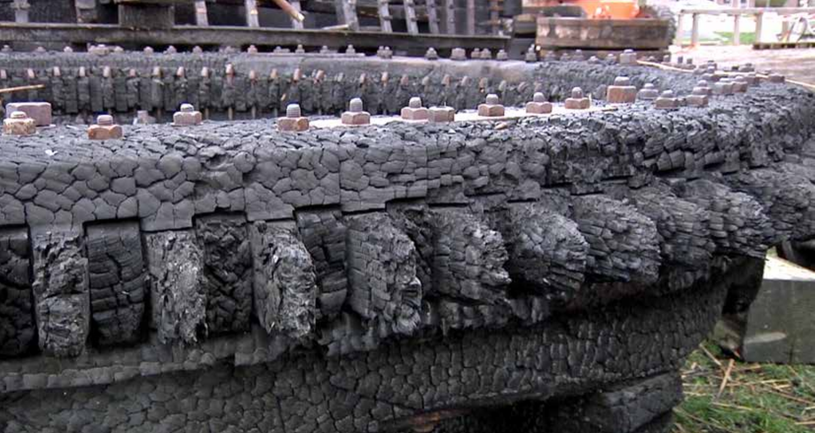
De belangrijkste onderdelen van het ernstig gehavende spoorwiel bleken toch nog te redden. Zie de volgende opname (foto molenaars Ceres).
