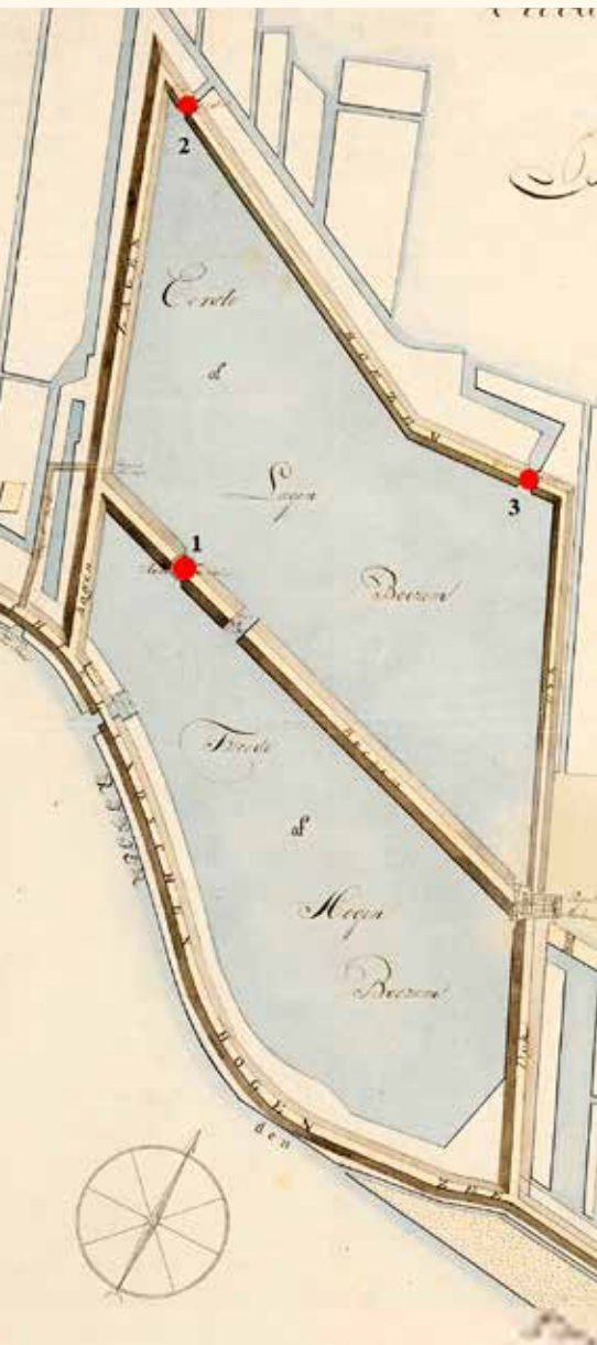
◀ 13. Beteugelingsmolens bij Kortenoord. Op de kade tussen de beide boezems staat de bovenmolen (1) met daarnaast een sluis. De beide ondermolens (2 en 3) brengen het water van de Zuidplas op de lage boezem (afbeelding uit het archief van het Hoogheemraadschap Schieland en de Krimpenerwaard).
