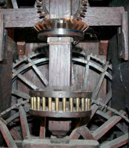
16. Molenmodel in het museum-stoomgemaal Cruquius, uitgerust met het vereenvoudigde stelsel. De beide schepraders hangen hier op verschillende hoogte. De ijzeren tandkrans van het ene rad wordt rechtstreeks vanaf de spil door een schijfloop aangedreven, het andere vanaf de bovenzijde met een tussen-as (foto Jos van Schooten).
