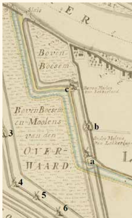
4. Kaart uit 1774 (Rijksarchief, inv. nr. 4204) met boven de Lek en rechts de beide oorspronkelijke poldermolens (a) en (b) van de polder Nieuw-Lekkerland, die uitmalen in een boezem. Daarboven de in 1740 gebouwde Hoge Molen (c), die in werking wordt gesteld wanneer niet rechtstreeks in de rivier kan worden uitgemalen. Linksonder in de bocht molen nummer 4 van de Overwaard, die was uitgerust met twee schepraderen.
