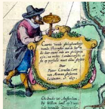
Een landmeter in 1607 met meetketting en hoekmeetinstrument.
