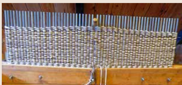
Een moderne haar wordt gevlochten op een standaard waarin een aantal staven is gestoken. Door het aantal staven te verminderen of te vermeerderen wordt de gewenste lengte van de haar verkregen.
