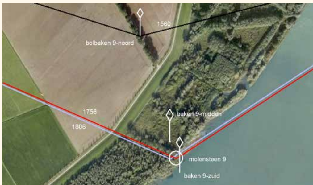
Situatie bij de bakens 9 in de Nieuwe Merwede met Google Earth als ondergrond. Bij de lijnen is het jaartal van de meting aangegeven waarmee de ligging berekend is (Jan Blaas).
