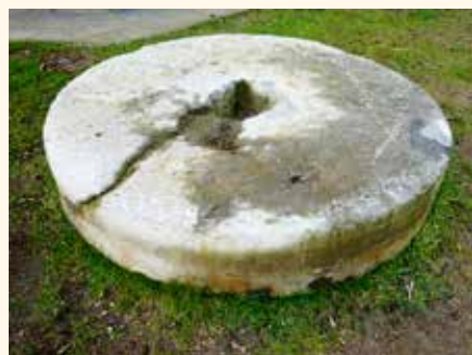
Kantsteen van een oliemolen, eerste vondst, 28 cm. dik met een diameter van 155 cm., gemaakt van Belgische hardsteen. Locatie Biesbosch Museum te Werkendam (foto Leen Rietveld).
