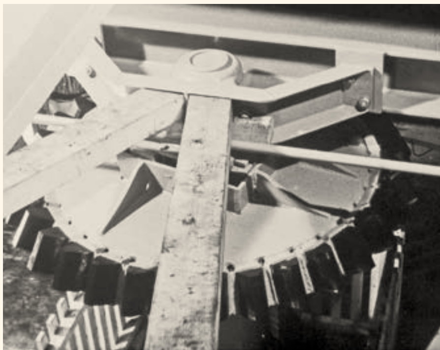
Stalen bonkelaar met celeron tanden (collectie Vereniging De Hollandsche Molen).
