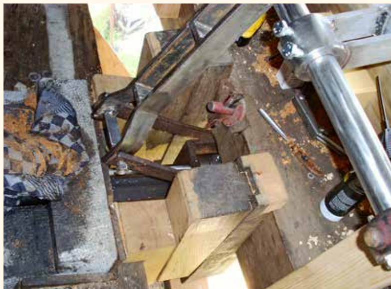
De gereconstrueerde bediening van de zwichtstang (foto M. Dellebeke, augustus 2019).
