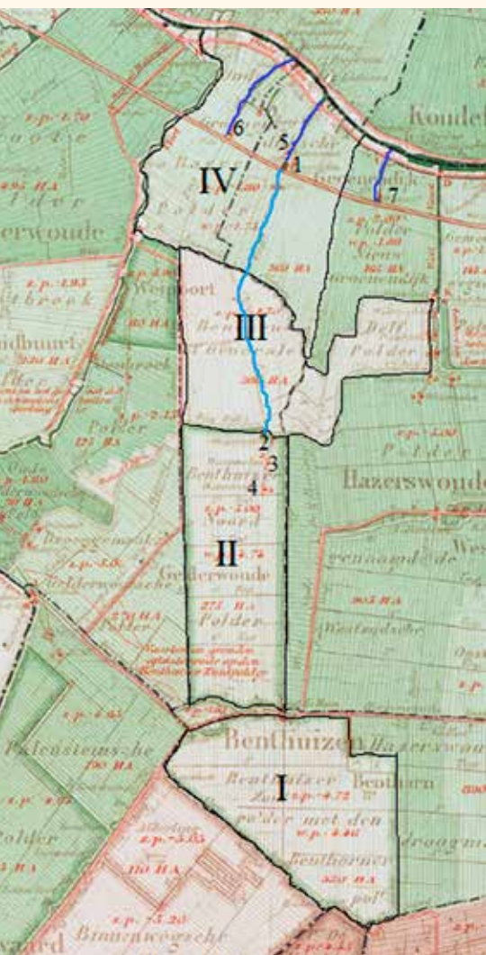
Waterstaatkundige situatie bij Benthuizen. I = Zuidpolder, II = Noordpolder (met daartussen het dorp Benthuizen), bemalen door de molens 1, 2, 3 en 4 (viergang). III = Bent- en Delf- of Generalepolder, bemalen door de Langelandsemolen (5), en IV is de Oude Groenendijksche- en Barrepolder, bemalen door de Barremolen (6). Molen 7 is de nog bestaande Groenendijksemolen die de polder Nieuw Groenendijk bemaalt (bron: Waterstaatskaart 1885).
