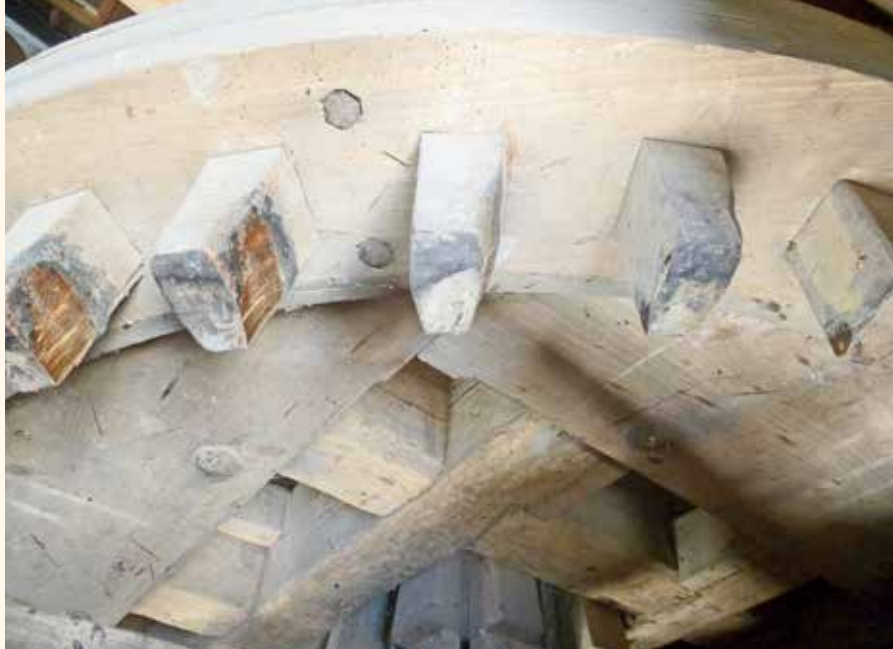
Traditioneel vormgegeven kammen in het onderwiel van de molen 'Hoop doet leven' te Voorhout. Dit onderwiel wordt aangedreven door een schijffloep. De houtsoort van de kammen is Surinaams groenhart (foto Willem Waltman).
