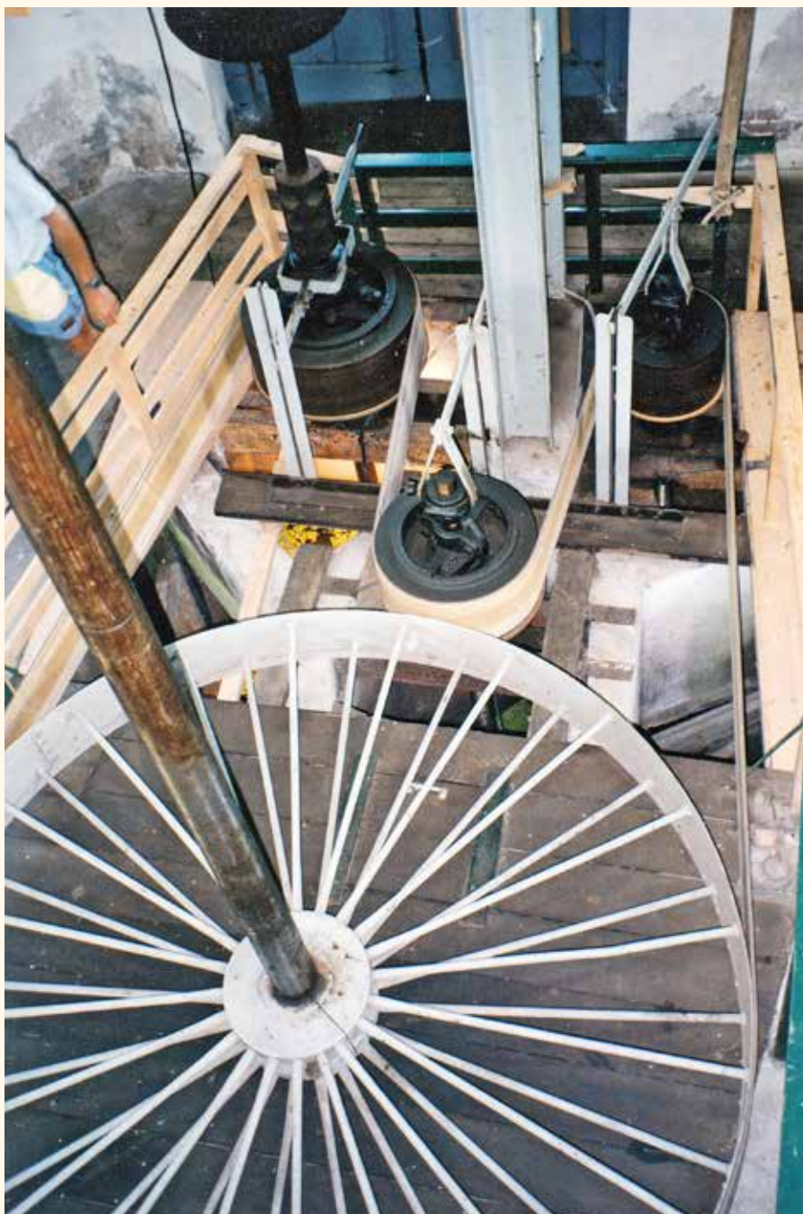
Aandrijving van drie pompen in de molen van de polder Waardenburg. Alle riemschijven draaien altijd mee, maar met de hefboomen kan men de pompassen stil laten staan of mee laten nemen, waardoor de pompen apart of gezamenlijk kunnen werken (foto Jan Hofstra, 1998).
