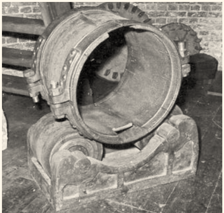
Dekkerlager, opgesteld in museummolen De Valk te Leiden. Let op de rechter rol die hoger is aangebracht en die aan de zijde van de keerstijl moet komen (foto I.J. de Kramer, 29 april 1971, collectie Vereniging De Hollandsche Molen).
