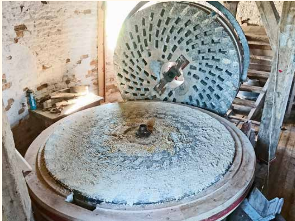
De molen in Wouw bezit nog steeds gatenstenen. Het zijn echter niet meer de stenen waarin Janus Potters eigenhandig de gaten hakte. Dit koppel moet aangekocht zijn omstreeks 1972 en is waarschijnlijk gefabriceerd door de firma Reijer Rutgers te Wageningen (foto Marijn Kaufman, september 2016).
