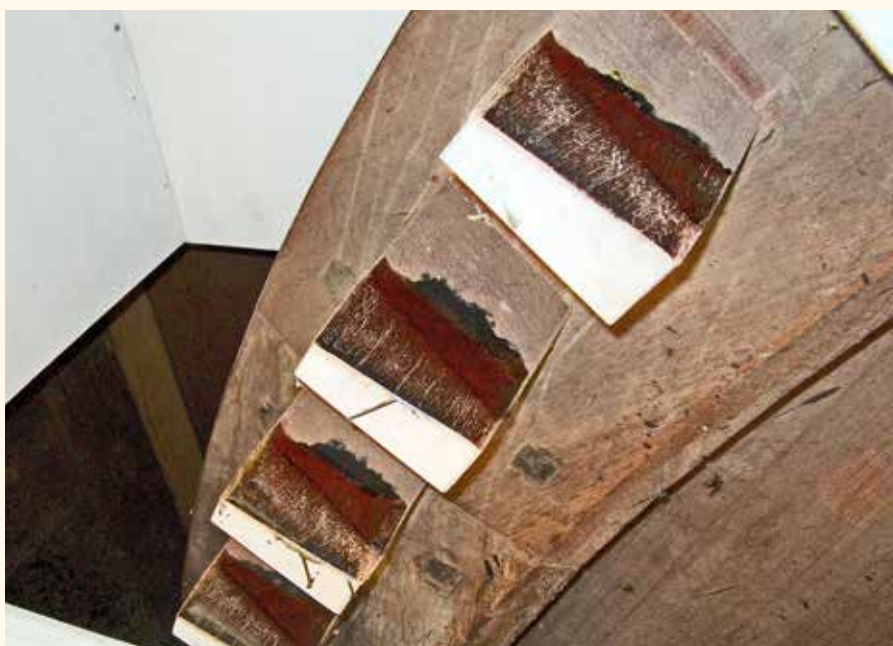
Kammen in het onderwiel van Molen No. 1 van de molenviergang te Aarlanderveen. Het onderwiel wordt hier aangedreven door een bonkelaar. De kammen zijn ontworpen naar de uitgangspunten van Jan van de Griend. De houtsoort is azobé (foto Jan van de Griend).
