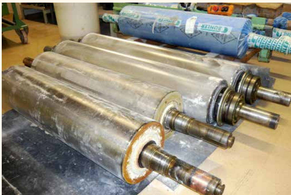
Waar een molensteen kerven heeft die aan de steen scherpte geven, heeft de moderne wals riffels, dat wil zeggen groeven die in de lengterichting van de wals zijn aangebracht. Na veelvuldig gebruik moet zo'n wals terug naar de fabriek om opnieuw geriffeld te worden. Er zijn ook zogenaamde gladwalsen zonder riffels (de voorste twee op de foto), maar ook daarvan moet het oppervlak van tijd tot tijd worden opgeruwd.
