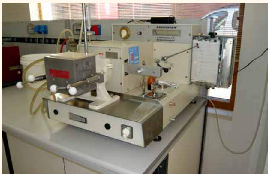
De fabriek heeft een eigen laboratorium, waar de bakwaliteit van de tarwe wordt onderzocht. Een van de instrumenten die daarbij gebruikt worden is de farinograaf, waarmee gegevens over de wateropname van het meel en over de deegontwikkeling tijdens het kneden worden verkregen.
