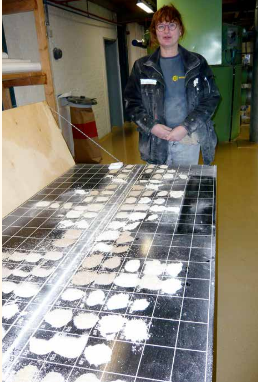
Het vermalen van de graankorrel via meerdere passages en het zeven door planschters levert vele verschillende componenten op, die al dan niet verder worden bewerkt. Op de foto staat molenaar Joan Moorlach aan de tafel waar monsters van al die producten worden uitgelegd, zodat het maalproces kan worden gecontroleerd.
