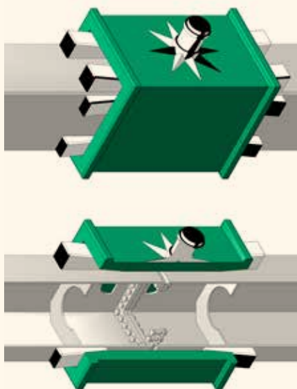
Schematische weergave van het principe-ontwerp van gedeelde roeden (tekening Erfgoed Advies Groen te Montfoort).
