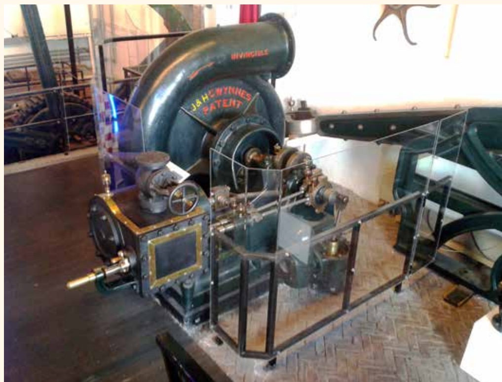
Stoommachine en centrifugaalpomp van de Spanbroekerkaag in museum De Cruquius.
