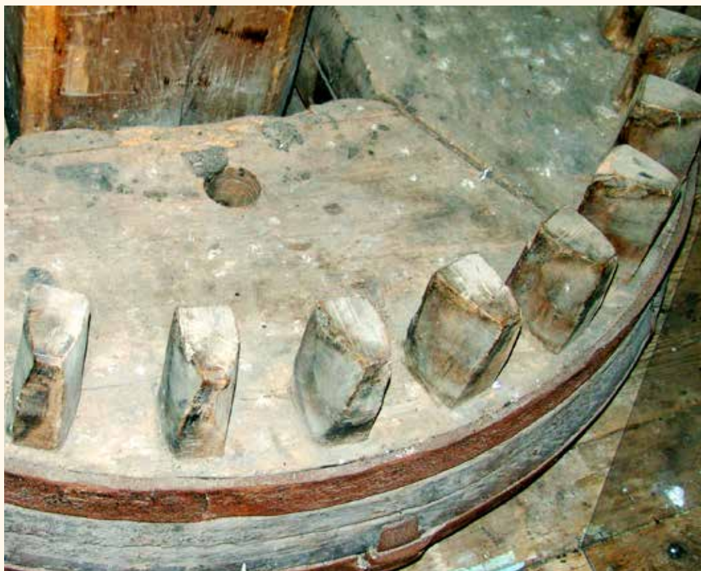
Bevroren in de tijd: de bovenbonkelaar van de molen van Acht (NB) die 75 jaar geleden voor het laatst functioneerde. Traditioneel gemaakte kammen met goede drukhoek.
