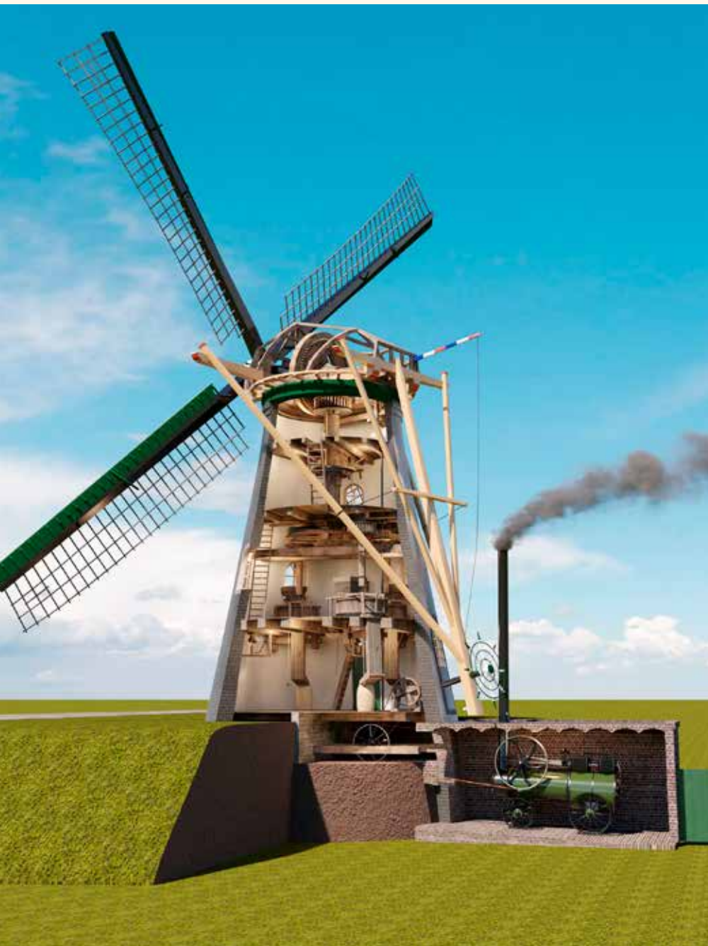
Voor een toekomstige film is een groot gedeelte van de molen opgemeten en in 3D getekend. Aan de hand van bouw- en slijtagesporen is getracht een beeld te vormen van het interieur, zoals het aanwezig was van 1902 tot circa 1914 (3D-model van Pieter Dorst, 2019).
