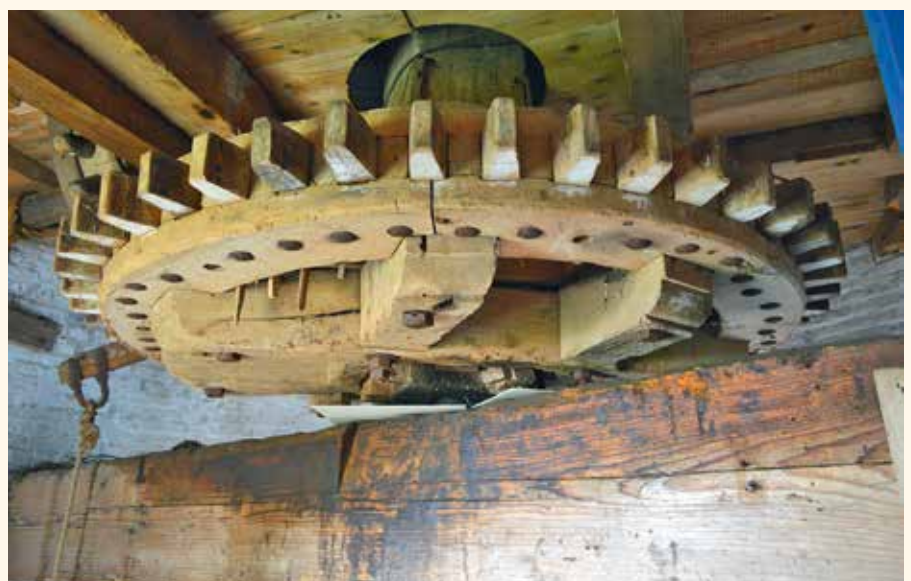
Het spoorwiel van de molen is bijzonder klein en waarschijnlijk nog uit de voorganger, een wipmolen, afkomstig. Het dreef ooit twee koppel stenen aan, momenteel nog één (foto Pieter Dorst, 29 juli 2016).
