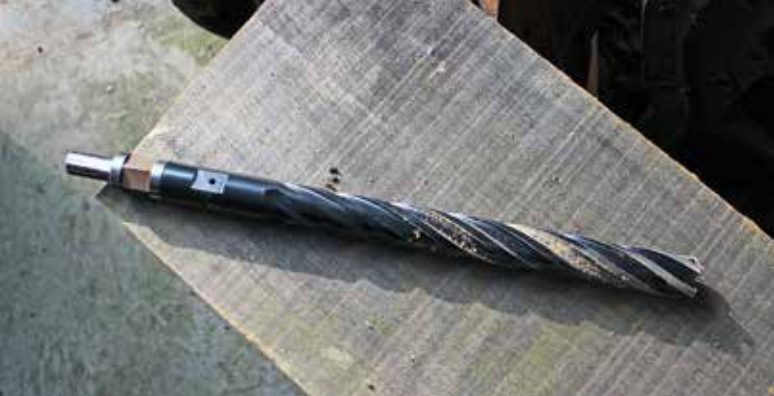
5. Holle boor om boommonsters uit houten balken te kunnen nemen (foto Van Reeuwijk bouwmeester).
