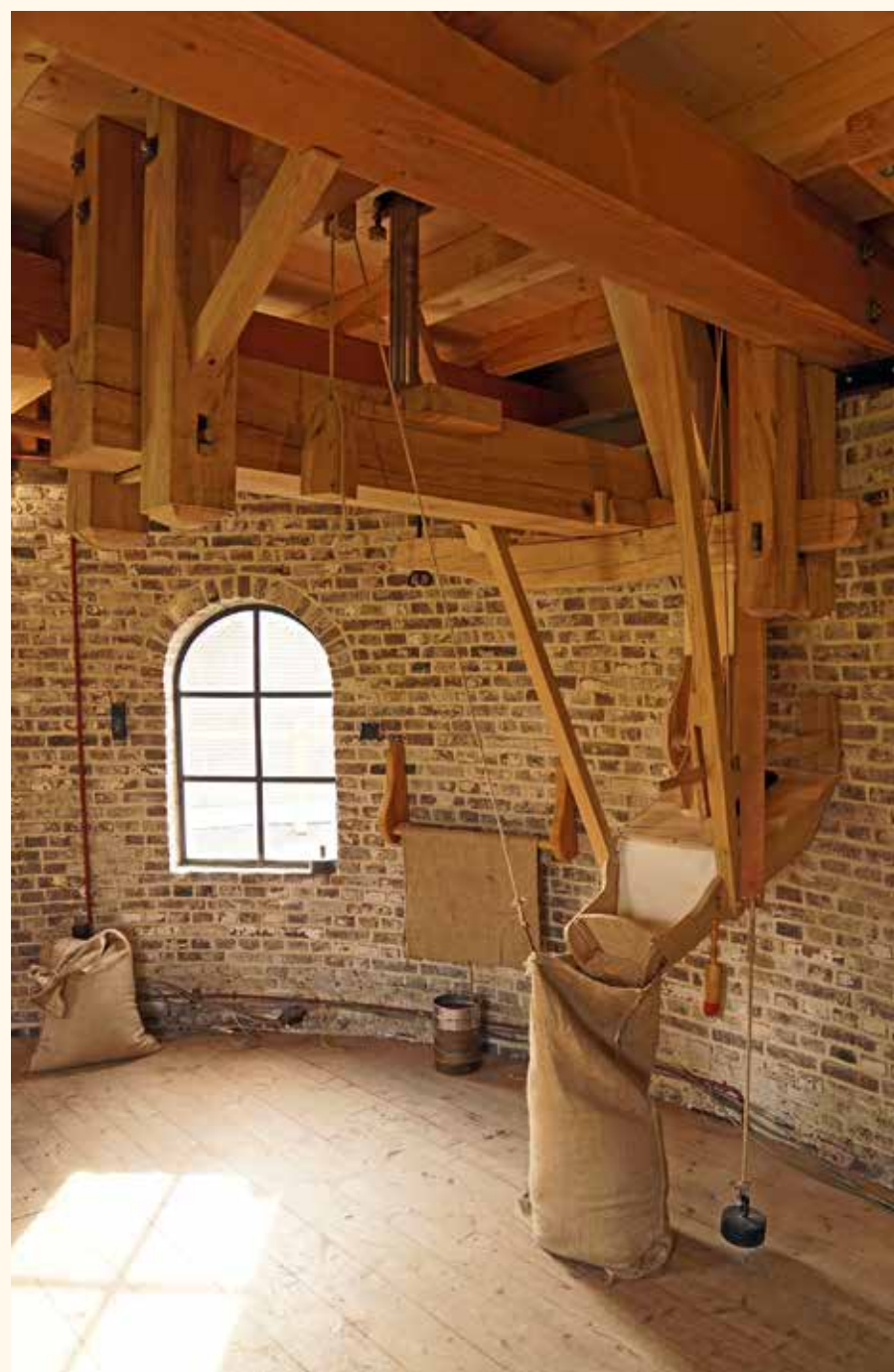
De maalzolder, met het nieuwgemaakte lichtwerk (foto Ton Meesters).
