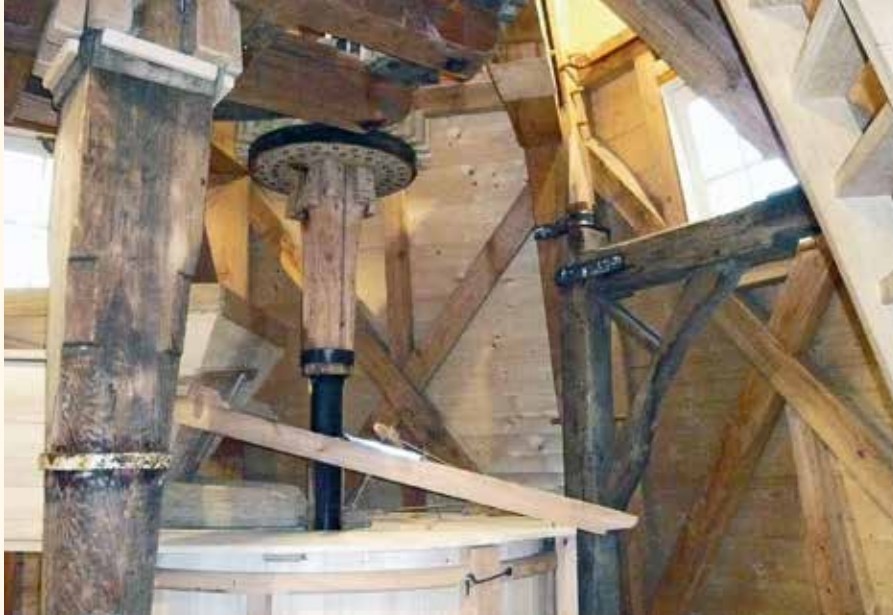
Op de steenzolder werden voorheen en worden de stenen nu weer aangedreven door een sterrewiel, in plaats van door een rondsel (foto Jan Scheirs).
