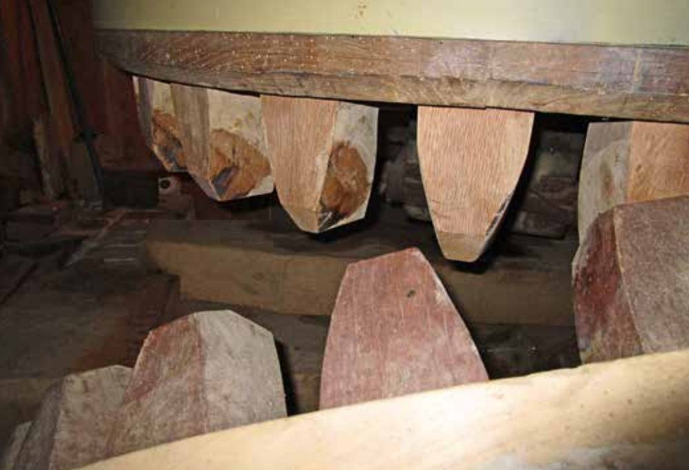
De kamprofielen van de onderbonkelaar en het vizelwiel op deze foto zijn ideaal voor een gemakkelijke overbrenging. De onderbonkelaar is goed in hoogte afgesteld, waardoor er geen instrijkvlakken zichtbaar zijn. Echt kritisch is die afstelhoogte echter niet, want met zulke mooie kamprofielen is licht instrijken best toelaatbaar.
