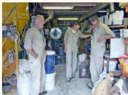
Behalve in de windmolen wordt er ook in de bij de molen gelegen maalderij gemalen. Hier liggen twee koppels stenen, die door een elektromotor worden aangedreven. Op de foto zien we Sjaak, Ruben en Michel (foto Willem Staat, september 2018).
