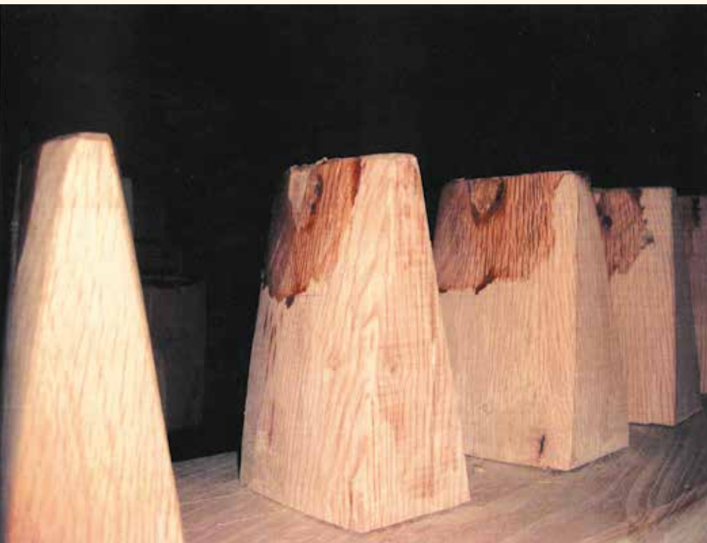
Kammen van de onderbonkelaar die het krukwielt aandrijft in een houtzaagmolen (Het Jonge Schaaap). Toestand na een korte inlooperperiode. Het krukwielt staat op de tweede foto. Tegen zoveel bruut geweld tussen de wielen met hun harde staven en kammen zoals hier getoond is niets bestand. Het is maar de vraag of een gesmede krukas op den duur ook niet zal bezwijken. De diepe inslag van de staven tijdens het instrijken en de inslag aan de achterzijde van de staven wijzen op een hoog frequent resonantieverschijnsel dat verantwoordelijk moet zijn voor de breuk van de krukas door vermoeiing. Het is van belang dat de kammen en staven snel inlopen waardoor het martelen van de krukas snel gaat afnemen, maar dat zal met het harde hout niet zo gauw het geval zijn. Beter is het te kiezen voor het zuivere kamprofiel, dat wel erg afwijkt van de traditionele vorm hier op de foto.
